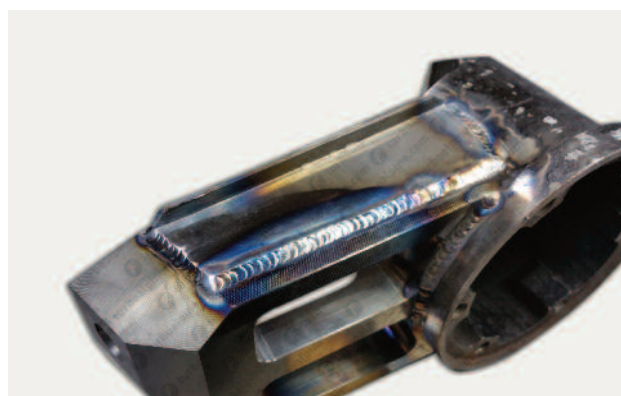
Reparation fusées Maxi 5 Reparación de manguetas Maxi 5 (si es posible)
